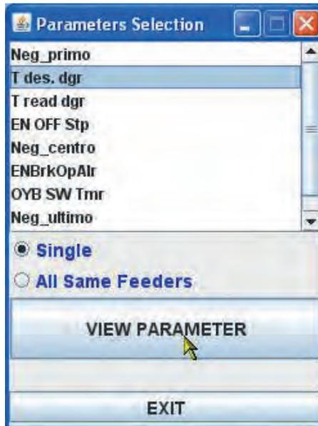
Per esempio, nella figura che segue, il KYC sta leggendo Tread dgr e Tdes dgr. Questi parametri sono scritti nel riquadro alimentatore perché sono stati selezionati dall'elenco (mostrata nella figura precedente). Il sistema è in modalità lettura continua (barra verde in basso in funzione e linea verde intorno allo schermo). Il valore dei parametri può variare.
